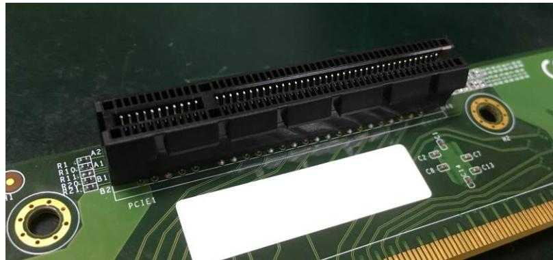
Figure 27 - PCIE x8 slot PCIE1
